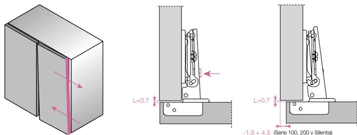
Una técnica especial de regulación permite un desplazamiento lateral de la puerta manteniendo inalterado el valor de "L" = 0,7 mm. El tornillo de regulación actúa adelantando el brazo de la bisagra.
