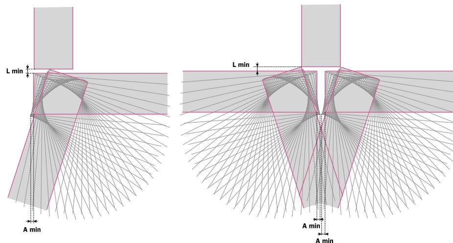
Simulación del movimiento de apertura de una bisagra 110° con puerta externa.
