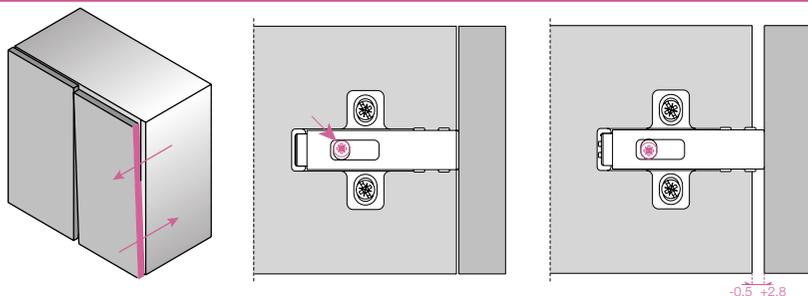
Utilizando las bases de montaje rápido Domi es posible regular frontalmente la puerta desde -0.5 mm hasta +2.8 mm mediante una excéntrica, sin tener que aflojar ningún tornillo.
