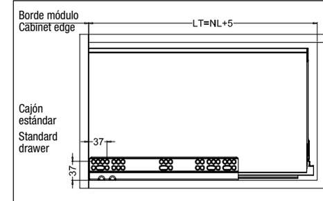
Medidas instalación cajón (mm)
