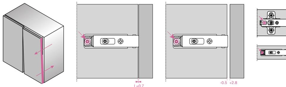
Es posible regular frontalmente la puerta desde -0.5 mm hasta +2.8 mm mediante una excéntrica, sin tener que aflojar ningún tornillo.
