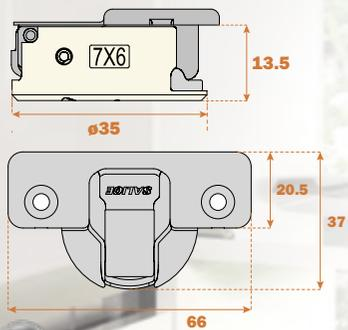
Bisagras con **sistema de amortiguación de dos pistones** con aceite de silicona, **regulable e integrado** en la cazoleta. Su **vanguardista selector +/-** permite regular la fuerza **desacelerante de forma constante** para un cierre perfecto para **cada tipo de puerta** y condición.
