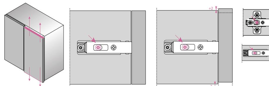
Es posible regular verticalmente la puerta a  $\pm 2$  mm mediante una excéntrica, sin tener que aflojar ningún tornillo.
