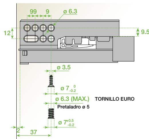
Guía de extracción total con **enganche del cajón mediante clip 3D**.
