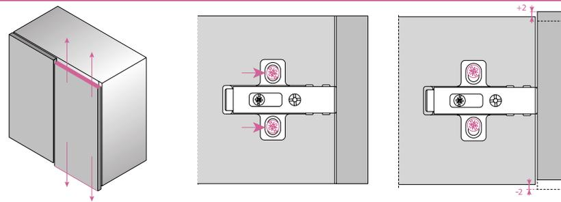
Aflojando los dos tornillos de fijación es posible regular verticalmente la puerta a  $\pm 2$  mm. Los orificios ovales permiten el desplazamiento de la base en los dos sentidos. Finalizada la operación, los tornillos deben ser apretados nuevamente.
